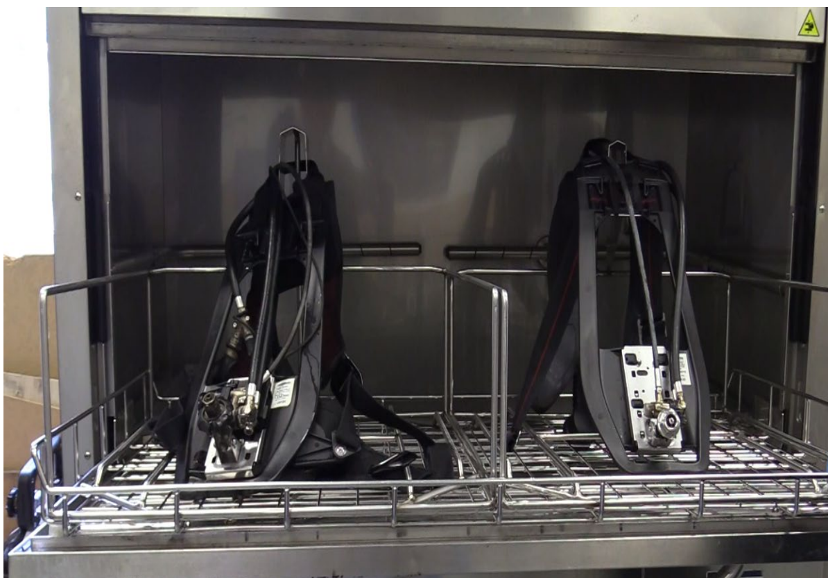
Bild 5. Bärställ tillhörande andningsapparater efter förbehandling och diskning i tankdiskmaskin med PPE Decon Cleaner
