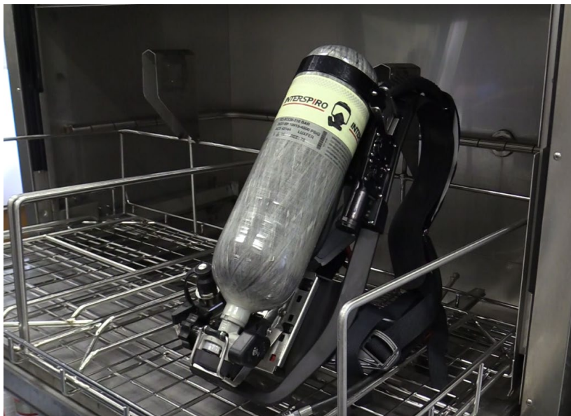
Bild 3 och 4. Andningsapparat och del till bärställ från bild 1 och 2 efter förbehandling och diskning.
