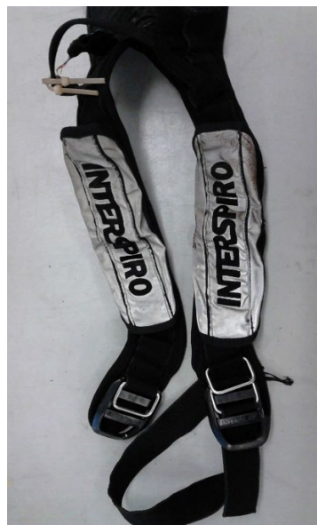
Bild 3 och 4. Andningsapparat och del till bärställ från bild 1 och 2 efter förbehandling och diskning.
